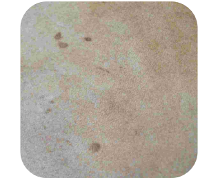
.Piaghe da parassitosi rimarginate .Healed parasitosis sores .Plaies dues à parasitoses cicatrisées .Wunden von teilweise verheiliter Parasitose
